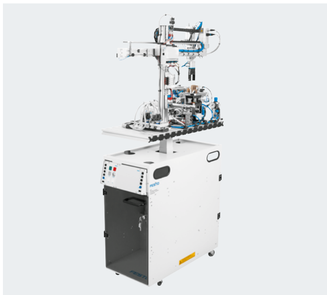
Station emballage avec équipement complémentaire
