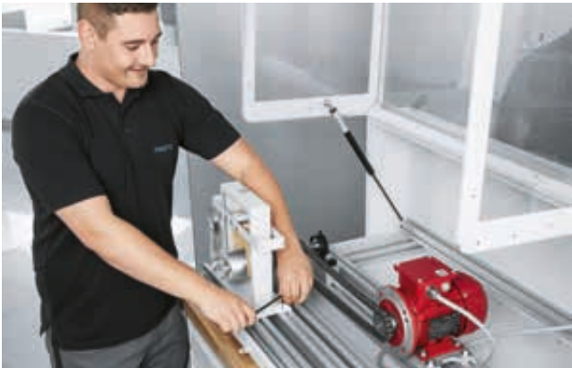
7. Mechanische Getriebetechnik Mit diesem Lernsystem werden die Lernenden in den wesentlichen Installations- und Instandhaltungsarbeiten an verschiedenen Getriebearten geschult.
