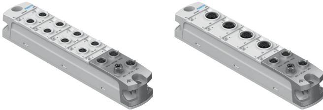
Die digitalen Ein-/Ausgangsmodule ermöglichen den Anschluss von Sensoren und elektrischen Verbrauchern mit einer Betriebsspannung von 24 V DC. Verbindet 4 Eingänge und 4 Ausgänge in einem Modul. Schaltlogik der Eingänge und der Ausgänge: PNP (plusschaltend)
