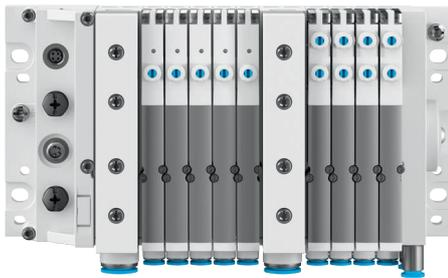
El terminal de válvulas modular de perfil bajo MPA-L está equipado con válvulas de alto rendimiento en una robusta carcasa metálica. Los tres tamaños de válvula, las numerosas opciones de concatenación en altura, la alimentación adicional y la descarga de aire pueden combinarse de forma flexible en la MPA. La puesta en funcionamiento es muy segura gracias al accionamiento manual auxiliar y a los LED de diagnóstico.
