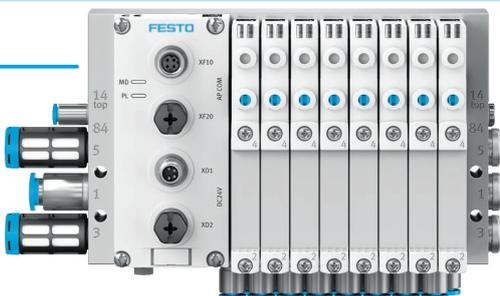
El terminal de válvulas compacto VTUG con válvulas de placa base y válvulas semi en línea está disponible en 3 tamaños. Sus válvulas, robustas y duraderas, están equipadas con un indicador LED y accionamiento manual auxiliar. En un terminal de válvulas pueden instalarse hasta 24 válvulas de consumo reducido.
