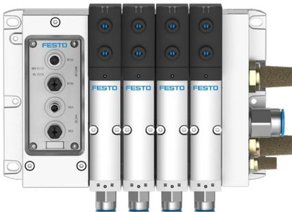
El versátil terminal de válvulas normalizado y configurable VTSA ofrece numerosas integraciones opcionales de funciones y funciones de seguridad. Los 4 tamaños pueden combinarse en un terminal de válvulas sin placa adaptadora. En un terminal de válvulas VTSA caben hasta 96 bobinas magnéticas de varias zonas de tensión. Gracias a sus componentes robustos y duraderos, el VTSA también es adecuado para aplicaciones industriales exigentes.
