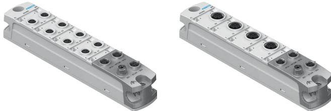
Los módulos de entrada/salida digitales permiten conectar sensores y receptores eléctricos con una tensión de funcionamiento de 24 V DC. Conecta 4 entradas y 4 salidas en un solo módulo. Lógica de conmutación de las entradas y salidas: PNP (de conmutación positiva)
