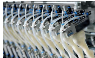
Kundenspezifische Zylinder-Ventil-Kombination von Festo für die Textilindustrie
