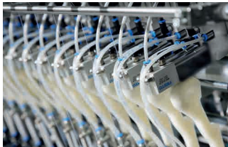
Combinazione personalizzata di cilindro-valvola Festo sviluppata per l'industria tessile
