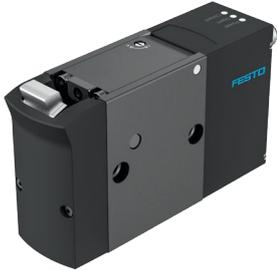
Der EFSD übernimmt das Stoppen von Werkstückträgern oder Verpackungsgütern. Durch den direkten Zusammenhang zwischen Masse und Fördergeschwindigkeit kann der Stopper z. B. 100 kg bei 6 m/min stoppen und bei 36 m/min sind bis zu 20 kg möglich. Zur Schonung des Transportgutes und des Stoppers verfügt er über eine vor Ort einstellbare Dämpfung. Das Dämpfungsmodul arbeitet dabei mit Umgebungsluft, ist wartungsarm und installationsfreundlich.
