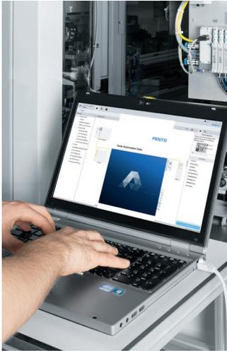
Die PC-basierte Software Festo Automation Suite vereint Parametrierung, Programmierung und Wartung von Festo Komponenten in einem Programm. Sie ermöglicht die Inbetriebnahme des gesamten Antriebspaketes von der Mechanik bis hin zur Steuerung. In der kostenlos verfügbaren Inbetriebnahme-Software sind die Grundfunktionalitäten aller Festo Komponenten bereits integriert.
