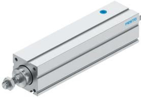
Der leistungsstarke und trotzdem günstige Elektrozylinder EPCC eignet sich für einfache Positionieraufgaben. Durch seinen Kugelgewindtrieb ist er gleichzeitig präzise und schnell wie auch robust und belastbar. Seine kompakten Maße sind ideal bei gegrenztem Einbauraum wie z. B. bei Montageanlagen, in Test- und Prüfsystemen oder bei Desktop-Applikationen, im Kleinteilehandling oder der Elektronikindustrie. Das gewichtsoptimierte Design verbessert die Dynamik und reduziert Taktzeiten.
