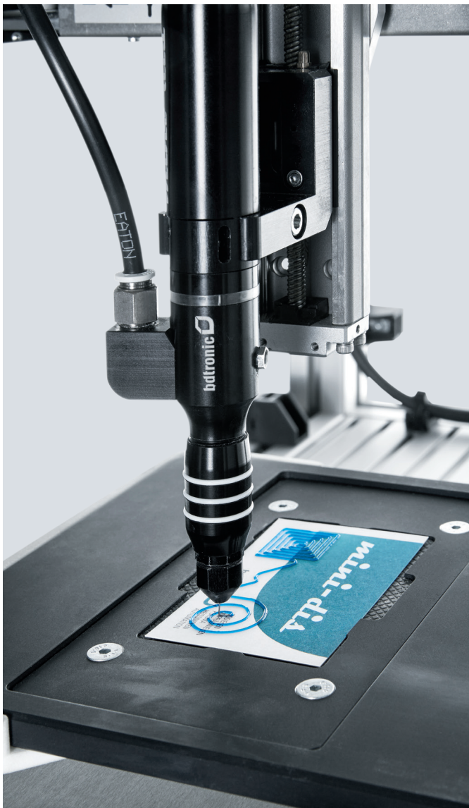
Präzise und flexibel: der neue Mikro Dispenser trägt mit der interpolierenden Steuerung CECC-X feinste Klebstoffbahnen auf.
