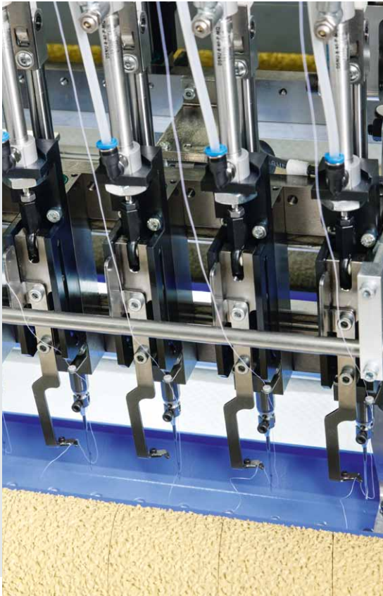
Die Vielnadelnähmaschine VMK Select arbeitet mit bis zu zwei Reihen von jeweils 96 Nadeln, jede einzelne davon schafft 1600 Hübe in der Minute.
