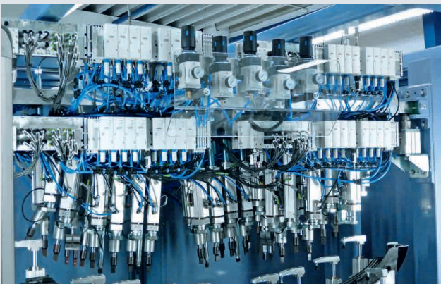
Maximierte Funktionalität – minimierter Platzbedarf: VPPM-MPA integriert im elektrischen Terminal CPX/MPA
