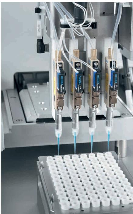
**Das automatisierte Pipettiersystem**, bestehend aus dem Pipettierkopf DHOE und dem Einwegspritzenabwerfer DHAO, kann Volumina im Bereich von 10 µl genau dosieren.
