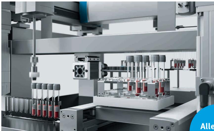
Mit den kompakten Handling-Systemen von Festo realisieren Sie Analyse-Anwendungen auf kleinstem Raum – von der automatisierten Probenvorbereitung bis zur Handhabung von Proben in der medizinischen Diagnostik.
