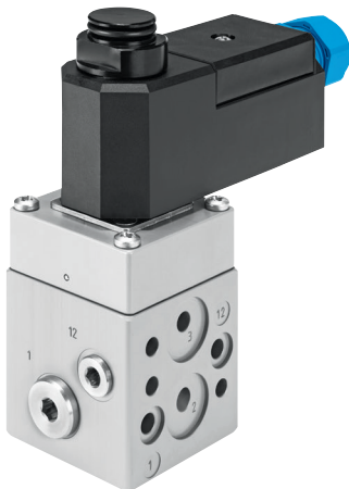
3/2-Wege-Kolbensitzventil mit erweitertem NAMUR-Anschluss und TÜV-Zertifikat gemäß IEC 61508
