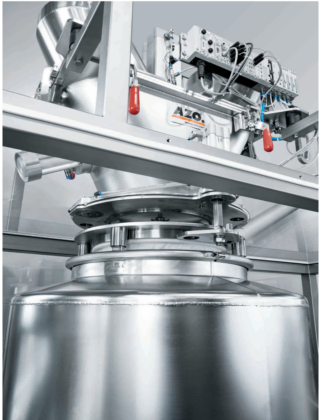
Les vérins linéaires Festo garantissent un serrage sécurisé de la pièce passive sur la pièce active.
