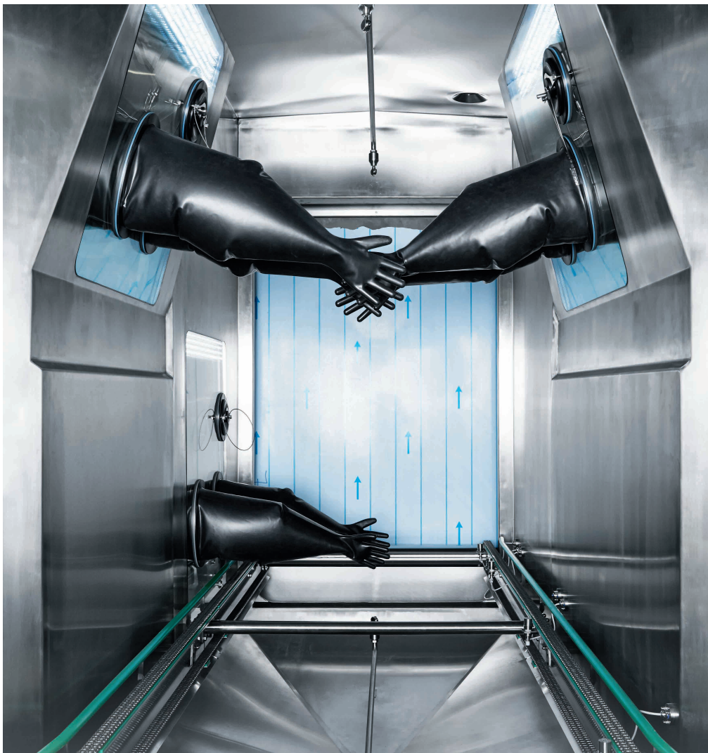
Sichere Reinigung: Personenschutzkabine zum Öffnen der Behälter mit Eingriffs-Gummihandschuhen.
