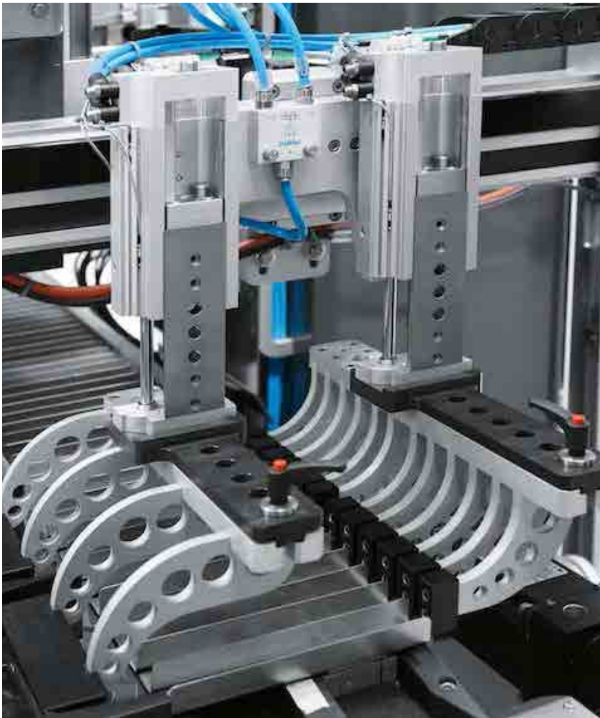
Abbildung 10: Zwei Festo DGSL Mini-Schlitten an einer elektrischen EGC-Achse in der seitlichen Ladevorrichtung einer modernen Verpackungsanlage
