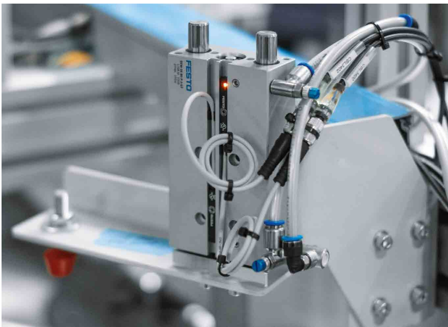
Abbildung 9: Das Basismodell der DFM-Serie ist der meistverkaufte pneumatische Führungszylinder von Festo.
