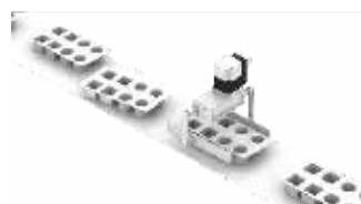
有杆电缸 EPCE 对齐泡罩包装
