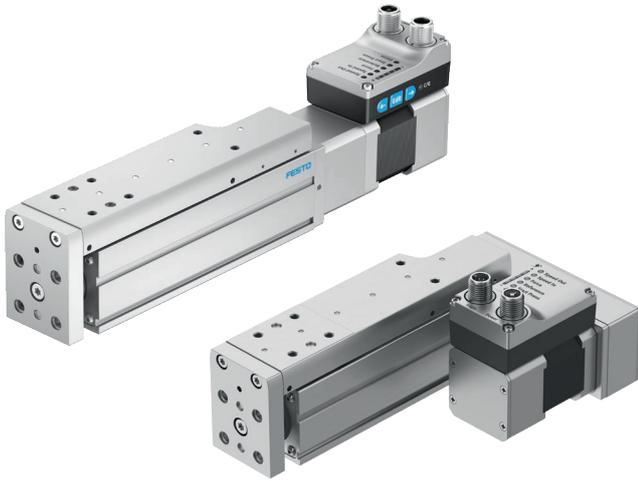
EGSS económico y resistente con marcha suave del husillo para movimientos Z verticales o en movimientos lineales individuales guiados en cualquier posición de montaje. La guía lineal interior absorbe las fuerzas transversales y ofrece una excelente seguridad contra la torsión en caso de pares elevados.
