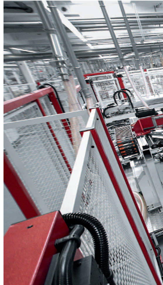
Automatisierungstechnik von Festo sorgt für die Bewegung der Fronten und Schubkästen von einem Montageschritt zum nächsten sowie für sicheres Halten und Klemmen zur Weiterbearbeitung.
