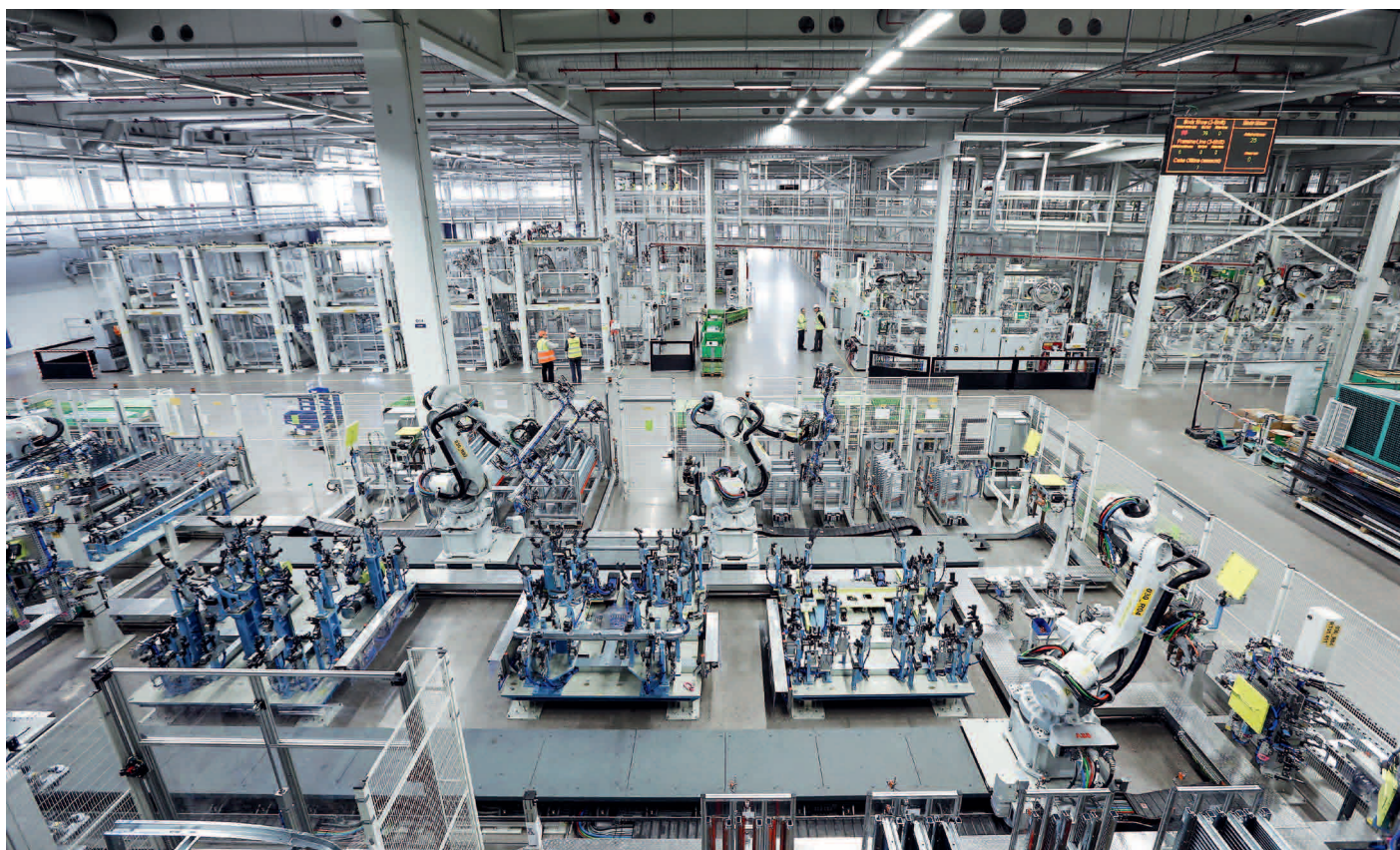
En la planta de Scania en Oskarshamn, 288 robots sueldan las cabinas de los camiones.
