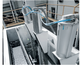
Commande de la vanne à clapet pour la régulation dans le traitement des minéraux.
