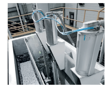
Commande de la vanne à clapet pour la régulation dans le traitement des minéraux
