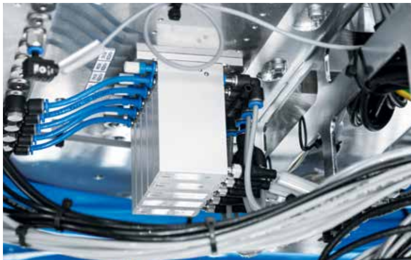
压电阀 VEAB 控制安装了多种焊接单元的焊接工具。
