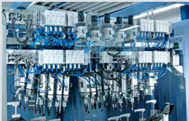
功能特性最大化 – 空间要求最小化：VPPM-MPA 集成到电气终端 CPX/MPA
