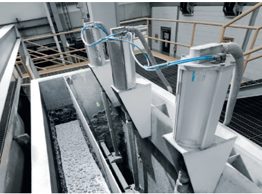
Control de la válvula dardo para la regulación de nivel en el procesamiento de minerales
