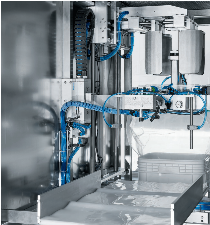
Beutel in Box: Aus einem Zuführmagazin entnimmt ein Handling per Vakuumgreifer die Beutel, die aufgeblasen werden, um in einer vorbereiteten Box Platz zu finden.
