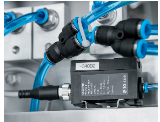
Festo Drucksensor SPAU mit IO-Link: Messung der zum Aufblasen der Beutel notwendigen Luftmenge.
