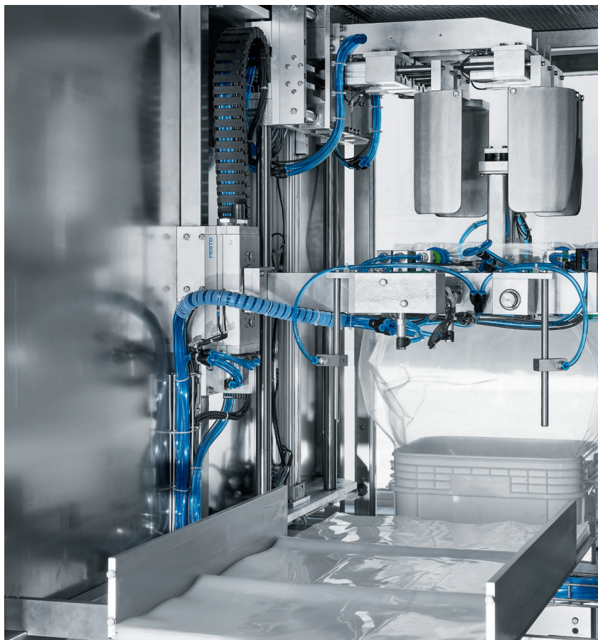
Bolsa en la caja: una ventosa de sujeción por vacío retira las bolsas que, a continuación, se inflan y se colocan en otra caja.
