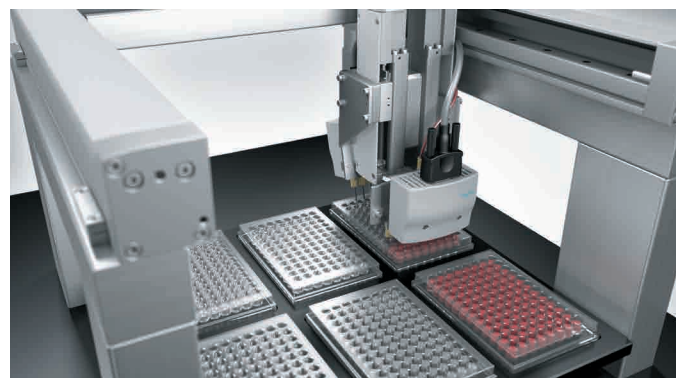
Analyse: Flüssigkeiten kontrolliert absaugen und präzise in Mikrotiterplatten dispensieren.
